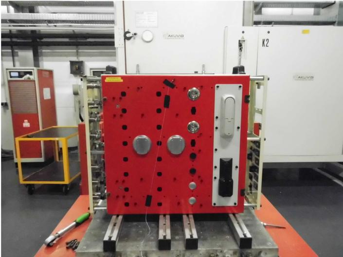
**Abb. 2: Prüflinge während der Schwingungs- und Schockprüfung in Horizontal 1**
