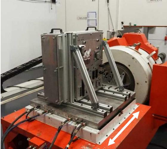
**Abb. 1: Prüflinge während der Schwingungs- und Schockprüfung in der ersten horizontalen Richtung**
